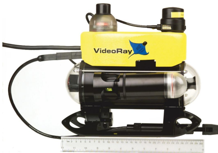
Рисунок 5 – ГКО Trittech, установленный на ROV малого класса VideoRay.
