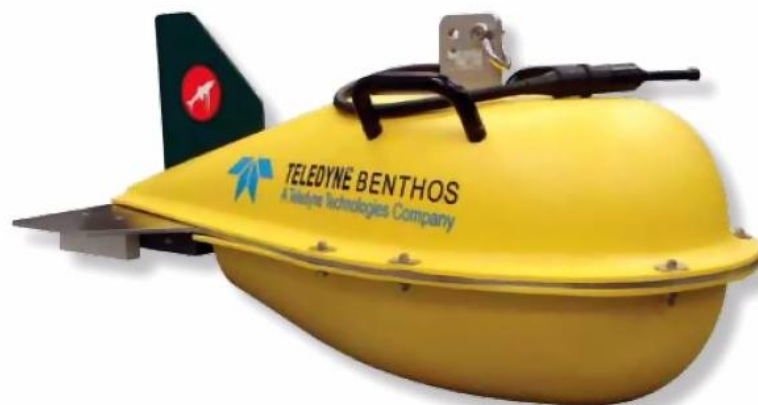
Рисунок 1 – Профилограф Benthos в буксируемом снаряде
