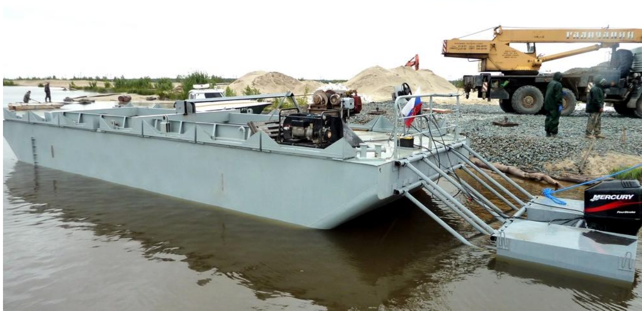
Рисунок 4 - Многофункциональная шаланда с установленным подвесным двигателем на плавучем транце.
